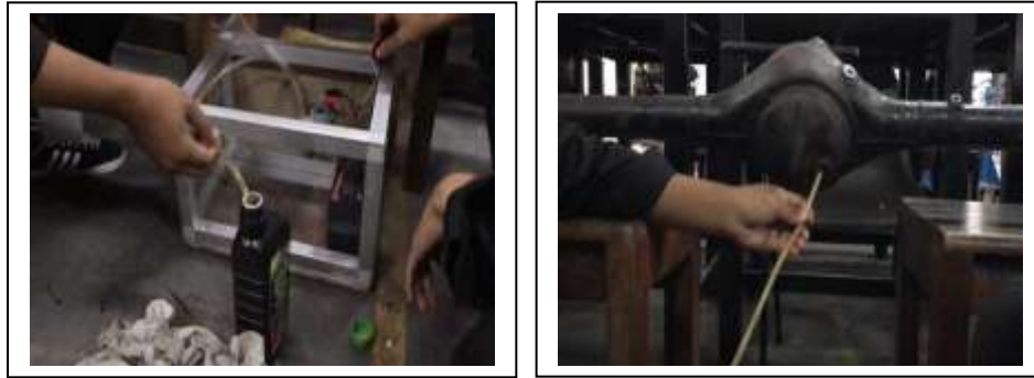
Rajah 6: Hos silicon dari pam vakum ke bekas simpanan minyak.
