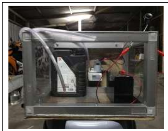
Rajah 8: Pemasangan alat bantuan penukaran minyak karbeda yang telah siap dipasang.
