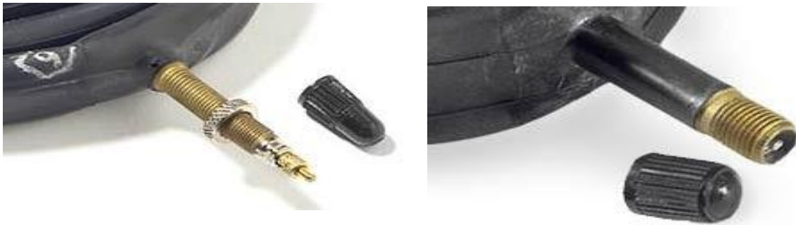
Gambar foto: Kiri-tiub jenis presta, kanan- tiub jenis schrader
